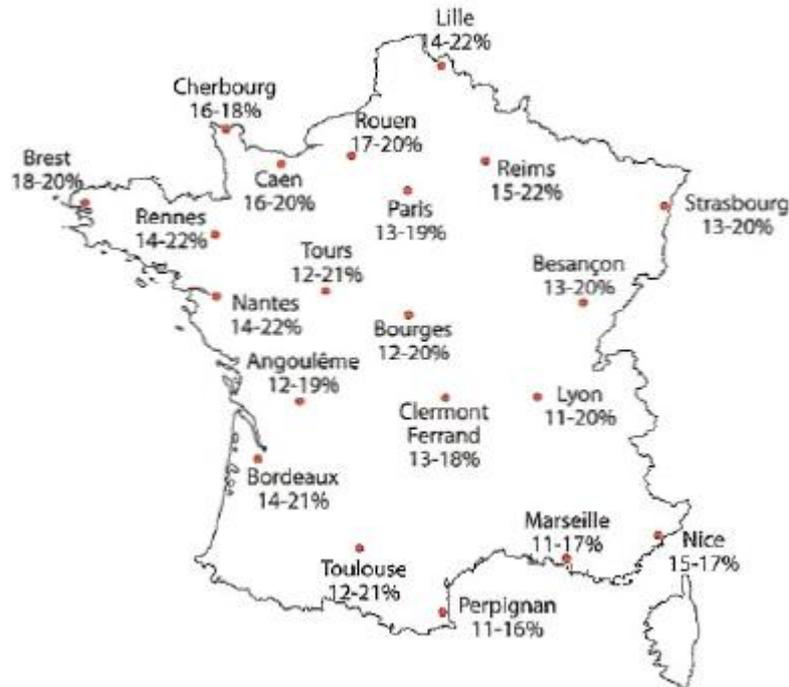
*Les chiffres indiquent les taux d'humidité relative moyens de l'air en juillet (à gauche) et en décembre (à droite). (Source : CNDB – FCBA)*
